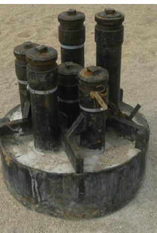
Aspetto final dos piezómetros AP
